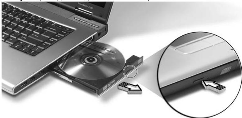
При отключенном питании вы можете вытащить лоток дисководов с помощью отверстия выброса при аварийных случаях.
